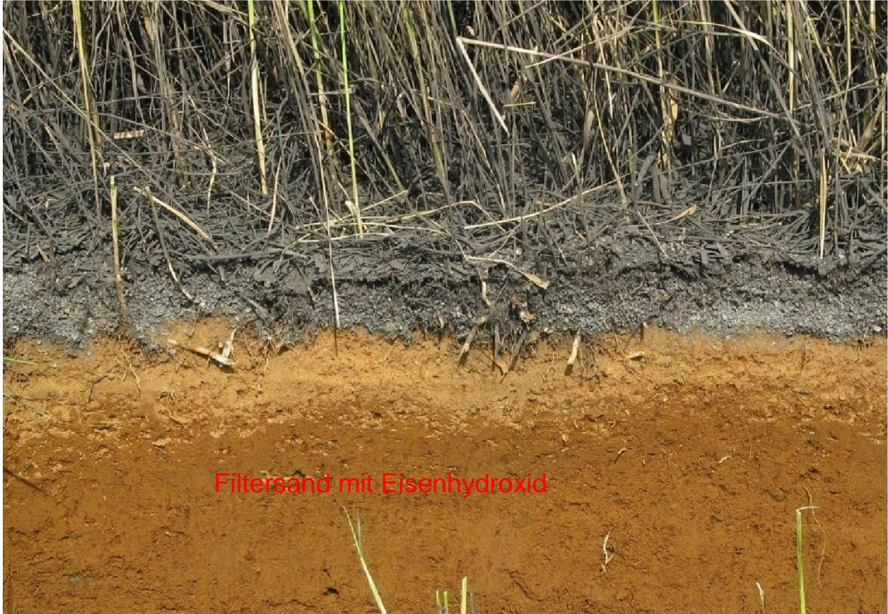
Durch Rückhalte- und Speicherkapazität des Filters für Phosphor wird eine P-Konzentration im behandelten Abfluss von 10 µg/l erreicht.
